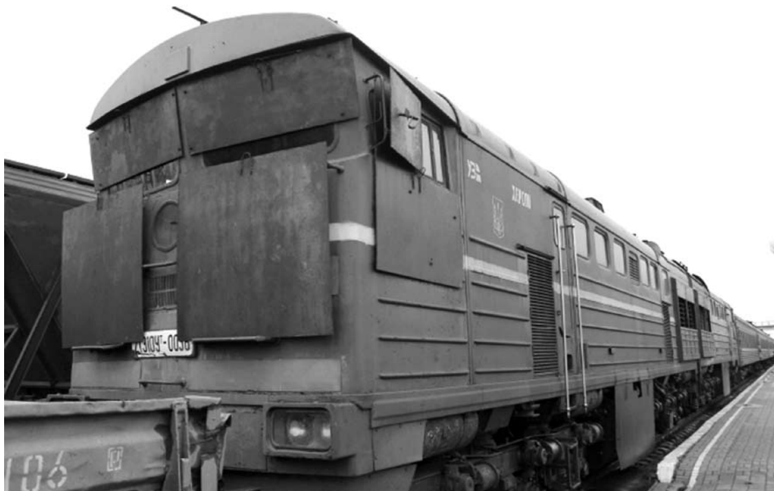
Traukinio langai yra apdėti metalo plokštėmis, kad skeveldros nesužeistų mašinistų.
